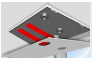
Verklebung von Anbauteilen
